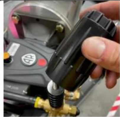
L'ajustement du régulateur (étape 7, ajustement des 2 écrous) peut prendre plusieurs essais avant d'arriver au bon ajustement, l'idée est qu'au moment où le régulateur arrive à la pression de l'unité la poignée arrive aux écrous de verrouillage. Généralement si vous régler les deux écrous de verrouillage de 3-1/2 à 4 tours dans le sens anti-horaire en partant du bas de la tige filetée, le régulateur devrait être ajusté a +/- 4000 psi pour une laveuse a pression de 4 gpm.
