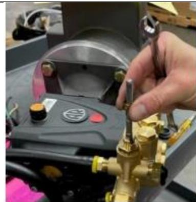
8- Utilisez deux clés pour serrer les écrous une sur l'autre de façon à les bloquer. Faites attention à ne pas trop serrer, vous pourriez endommager les filets sur la tige.
