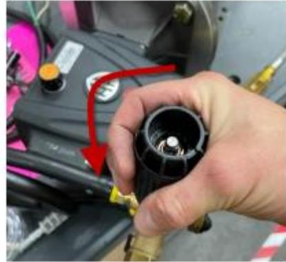
4 – Retirer la poignée d'ajustement et la mettre de côté pour l'instant.
