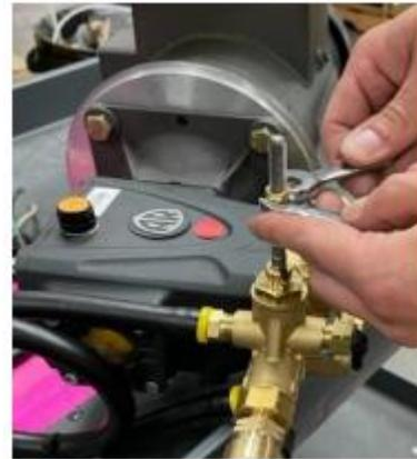
7- Ajustez les deux écrous à environ moitié chemin sur la tige filetée du régulateur pour régler la pression maximale du régulateur. Il se peut que vous ayez à répéter cette étape plusieurs fois pour avoir le bon ajustement.
