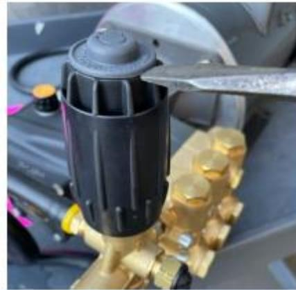
2- Retirer complètement l'écrou de blocage en la dévissant avec un outil approprié (douille 1/2" ou 13mm)
