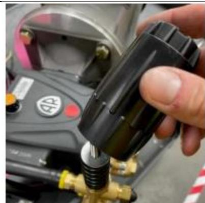
5- Retirer le ressort et la rondelle pour exposer les deux écrous sur la tige fileté.
